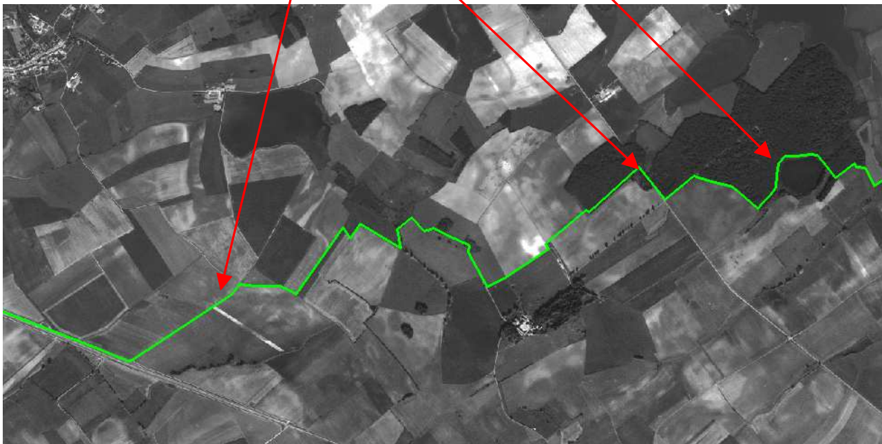
Limite de moindre différence (cut-line) entre 2 ortho-images Panchromatique 2007
