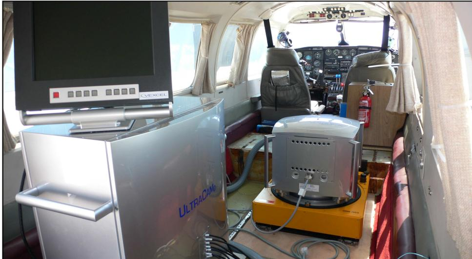
L'orthophotographie a été réalisée en appui des images acquises par la caméra numérique Vexcel UltraCAM-D n°28 embarquée dans notre avion Piper PA-31 dont les principales caractéristiques de vol sont les suivantes :
