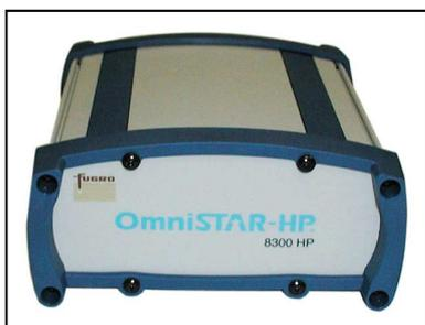
Le système dGPS d'OmniSTAR est composé d'un récepteur GPS L1/L2 12 canaux couplé au calculateur CCNS 4 et AEROcontrol qui contrôle la caméra et plusieurs paramètres incluant les compensations de dérive, le recouvrement longitudinal et enregistre les observations dGPS corrigé en temps réel par le service OmniSTAR.
