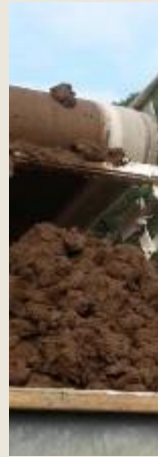
Boues déshydratées chaulées
