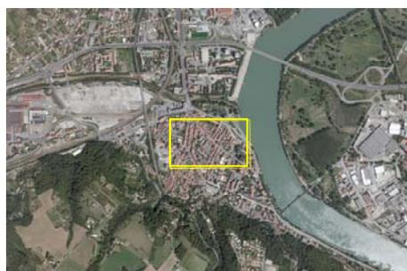
4) Empreinte utile pour la réalisation d'une ortho vraie sur un seul cliché (recouvrements 80% - 80%).
